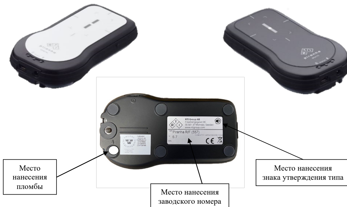
Рисунок 1 – Общий вид дозиметра Piranha с указанием места пломбирования от несанкционированного доступа, мест нанесения знака утверждения типа и заводского номера
