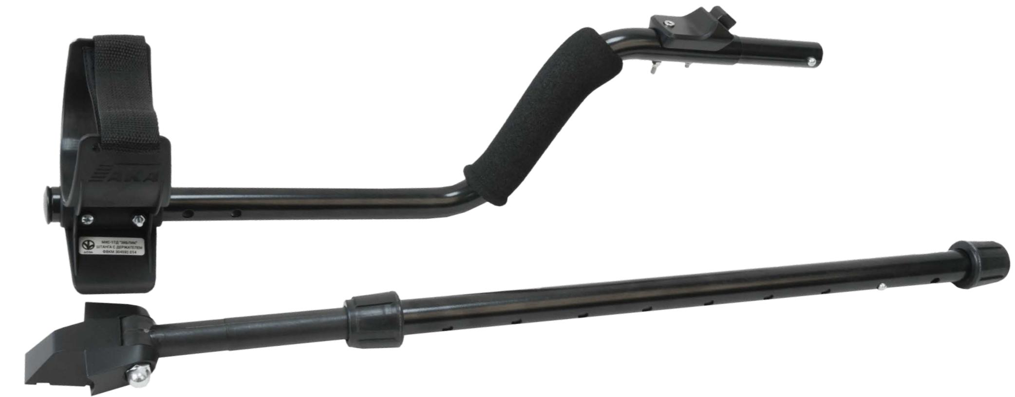
Быстросъемные соединения элементов прибора позволяют производить моментальную сборку в нужной конфигурации: ручка или штанга, выбор и установка нужного блока детектирования.
