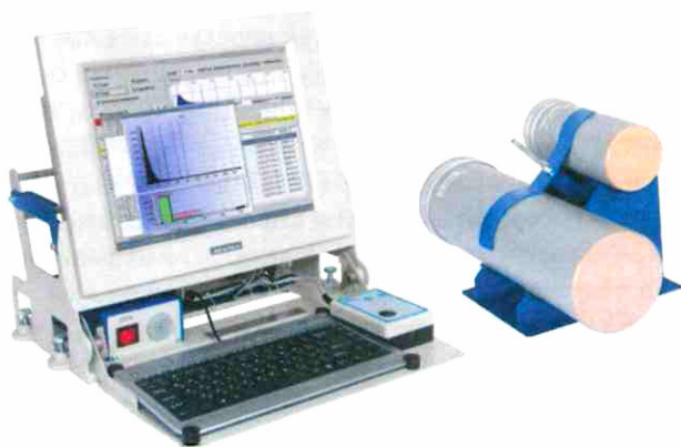
Рис. 2. Установка «Гамма-сенсор» на базе компьютера «Advantech» с блоками детектирования БДЭГ-4 и БДМГ-200
