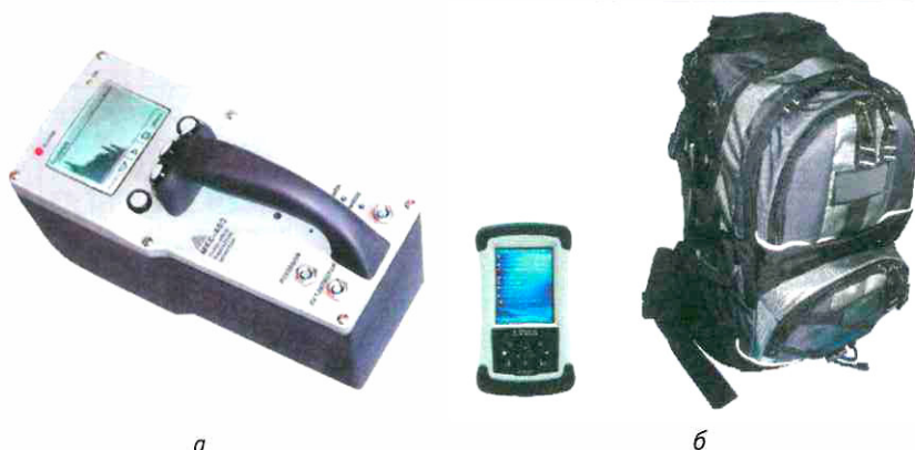
Рис. 3. Полевые портативные гамма-спектрометры МКС-03А (а) и МКС-АТ6101 (б)
