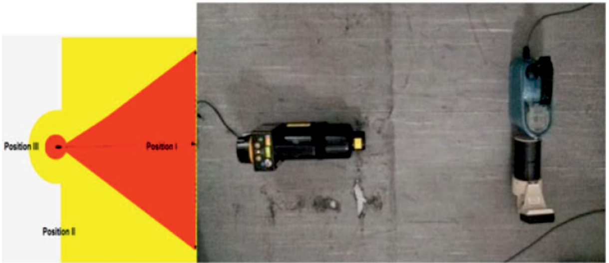
Рис.2. Измерительные позиции. Желтый цвет – безопасное место по данным производителя. Красный цвет – максимальная мощность дозы 20 мкЗв·ч -1 .
