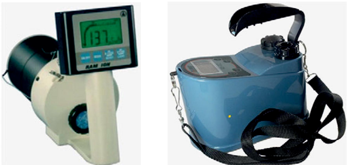
Рис.1. Два дозиметрических прибора с ионизационной камерой. Слева – Ram Ion. Справа – RI-02.
