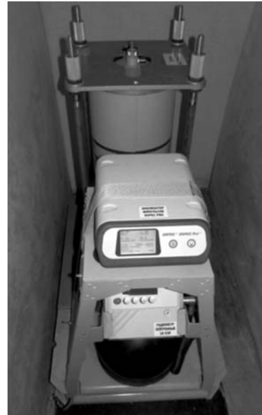
Рис. 1.4.5. Компонетка гамма-спектрометра высокого энергетического разрешения и радиометра нейтронов LB 123 N фирмы Berthold на амортизационной раме.
