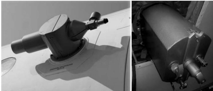
Рис. 1.3.2. Фото проточной (слева) и шлюзовой части шлюзового заборника аэрозолей "Вега-1М".
