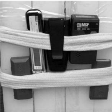
Рис.2. Расположение дозиметров на фантоме во время облучения на ускорителе. Одновременно облучались ДВС-01С, DMC 2000 GN, ДВГН-01, PDM 303.
