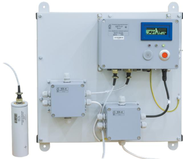
Автоматические измерения объемных активностей радионуклидов в воздухе в составе системы АСКРО
