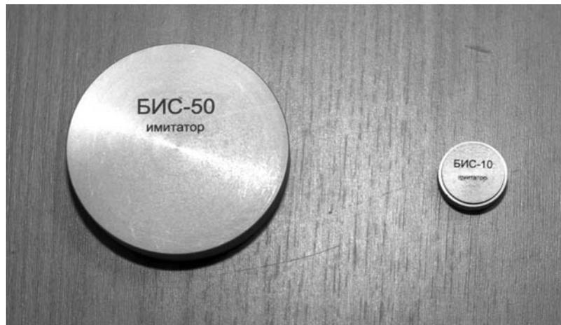
Рис. 1б. Внешний вид источников БИС-50 и БИС-10.
